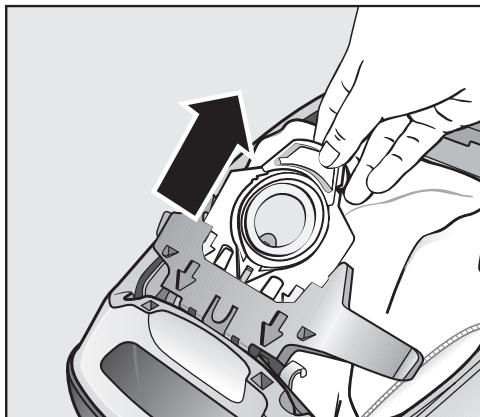
Блокування холостого ходу роботи перешкоджає закриванню кришки пилового відсіку, якщо пилозбирник відсутній. Не застосовуйте силу!
